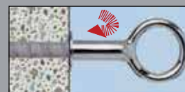
4. Attendere l'indurimento della resina e avvitare il golfare
