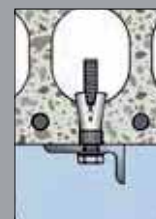
Serrare mediante chiave dinamometrica applicando la coppia di serraggio prescritta
