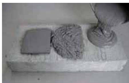
Fluidità regolabile in base all'aggiunta di sabbia di quarzo
