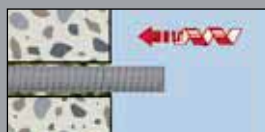
3. Iniettare la resina WIT-VM 200 e inserire la barra filettata con leggere rotazioni
