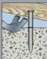
2. Levare la tavola, il chiodo resta implementato nel calcestruzzo
