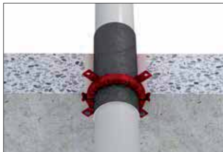
A soletta: un solo manicotto sulla parte inferiore.
