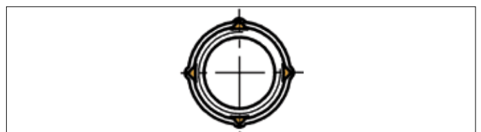
L'ancorante a montaggio eseguito: ad espansione avvenuta l'utensile d'espansione lascia sulla circonferenza del tassello 4 tacche di controllo (in arancione). Solo se queste tacche sono visibili il carico può essere applicato.
