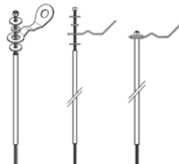
Montaggio tipo su copertura ventilata in legno
