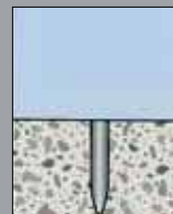
4. Il chiodo rimane aderente alla superficie del calcestruzzo
