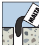
Versare nei fori senza incorporare aria
