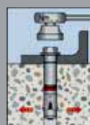
4. Avvitare mediante chiave dinamometrica applicando la coppia di serraggio prescritta.
