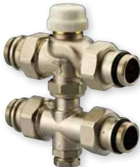
Permette di intercettare una zona dell'impianto di riscaldamento, abilitando o disabilitando la distribuzione di acqua calda alle utenze. Si tratta di una valvola a tre vie con un ingresso e due uscite. La testina elettrotermica, gestita dal termostato di zona, agisce sull'otturatore aprendo una delle due vie secondo delle esigenze.
