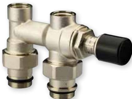
Evita che il valore di pressione differenziale tra il circuito di mandata e ritorno del collettore superi il valore impostato. Tale condizione potrebbe, ad esempio, verificarsi nel caso di chiusura di tutte le testine termostatiche poste agli ingressi dei radiatori. Il campo di regolazione varia tra 0,2 e 0,6 bar. Questa valvola offre inoltre la possibilità di montare delle valvole di sfiato manuali o automatiche per consentire la rimozione dell'aria accumulatasi all'interno del circuito.
