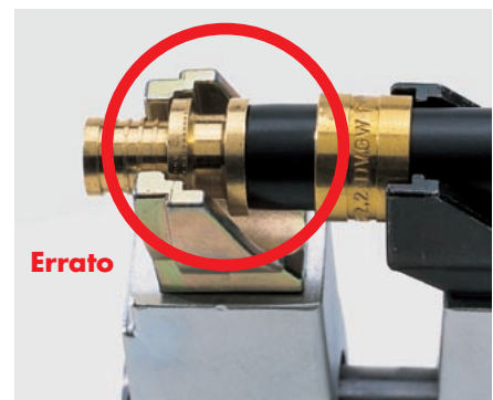
Posizionamento errato della forcella F sul collare del raccordo. La giunzione subirà una sovrappressione.
