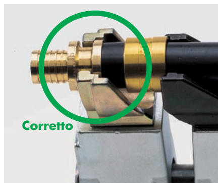
Posizionamento corretto della forcella F sul collare del raccordo con MSZ.
