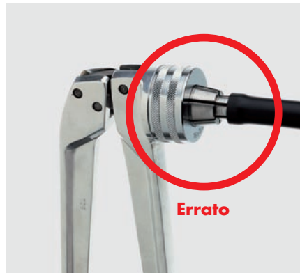
Innesto incompleto del tubo
