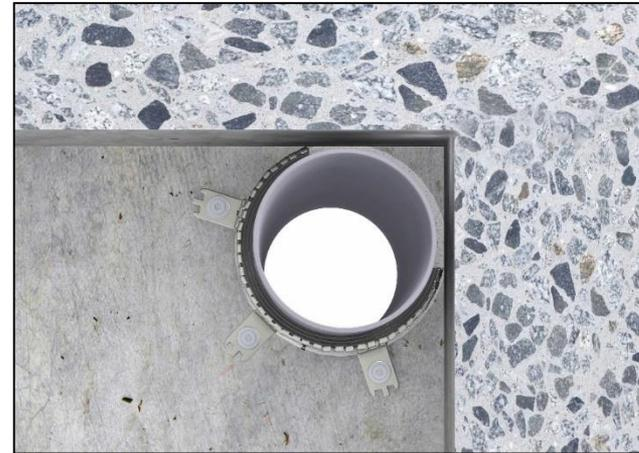
Tubi in plastica verticali posti direttamente **in angolo** con le pareti, a solaio (distanza max. tubo/parete 10 mm)
