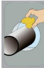
2. Inserire lana di roccia in modo compresso e dello spessore necessario a seconda del tipo di sigillatura
