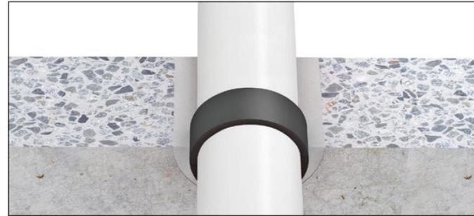
A solaio: applicazione del nastro solo a filo del lato inferiore del solaio
