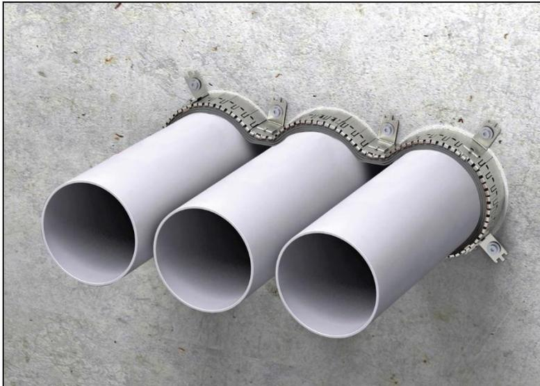
**Tubi multipli** in PVC, PE o PP con  $\varnothing$  est.  $\leq 75$  mm avvolti con un unico collare condiviso, a parete e a solaio (distanza max. tubo/tubo 15 mm)
