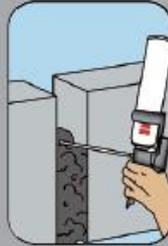
Agitare la bombola e riempire il giunto tramite pistola. Se necessario infilare, prima di schiumare, la lana di roccia ben compattata.
