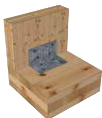
Angolare Denek con 8 x ASSY®plus 4 Kombi VG Ø 12 x 160 mm
