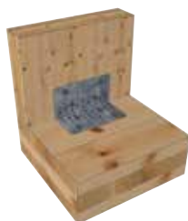
Angolare Denek con 70 x Chiodi scanalati Ø 4 x 60 mm
