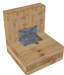
Angolare Denek con 18 x ASSY® 4 JH Ø 5 x 70 mm + 8 ASSY®plus 4 Kombi VG Ø 12 x 160 mm
