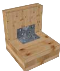
Angolare Denek con 8 x ASSY®plus 4 CS VG Ø 6 x 200 mm con rondella
