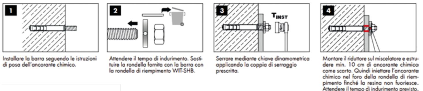
Nella definizione dello spessore da fissare  $t_{fix}$  è necessario considerare il maggior spessore della rondella di riempimento rispetto alla rondella normale.
