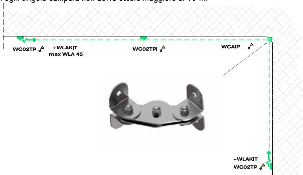
**WCAIR** - Il dispositivo, angolare interno per ripartenza funi, prevede l'interruzione della fune, pertanto le due campate che si staccano devono essere dotate di proprio riduttore di tensione. La verifica delle azioni viene effettuata considerando come se fosse un terminale di estremità. La lunghezza di ogni singola campata non dovrà essere maggiore di 15 m.
