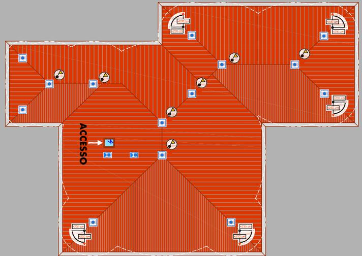
fig. 7 Impianto anticaduta Tipo A con accesso da lucernario
