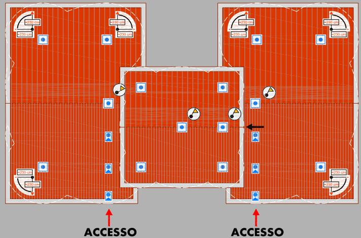
fig. 9 Impianto anticaduta Tipo A su copertura a tre livelli con due accessi dall'esterno
