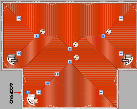
fig. 8 Impianto anticaduta Tipo A con accesso dall'esterno
