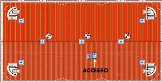
fig. 3 Impianto anticaduta Tipo A / Classe A1-A2 con accesso da lucernario
