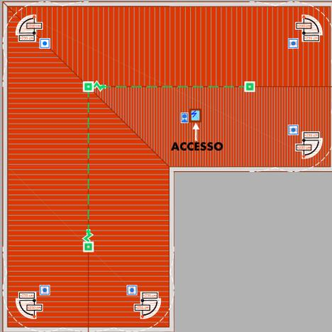
fig. 1 Impianto anticaduta Tipo C con accesso da lucernario
