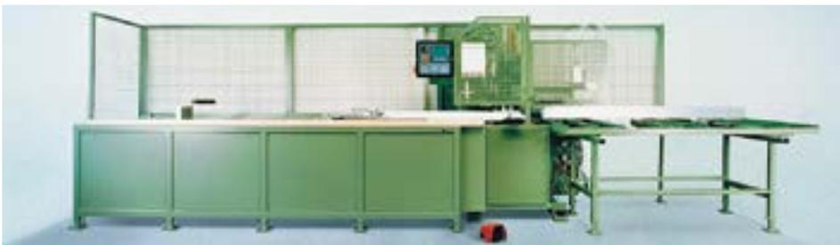
Grazie alla punta extra lunga autoforante, è specifica per profili in PVC con rinforzo di spessore fino a 3,5 mm
