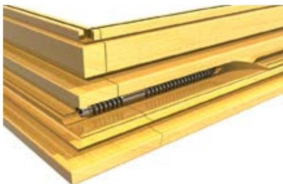
**Utilizzata, specialmente negli angoli, come unico elemento di collegamento per l'avvitamento delle ante in legno**
