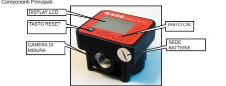
L'elettronica di misura e il display a cristalli liquidi «LCD» sono installati nella parte superiore dei contaltri, isolata dalla camera di misura bagnata dal fluido e sigillata dall'esterno tramite un coperchio.
