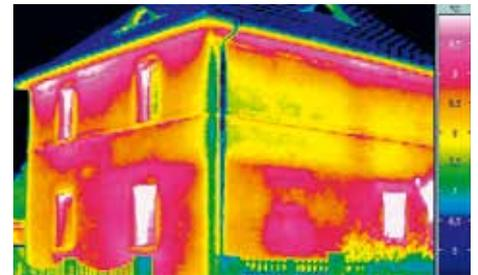
Spesso le schiume poliuretaniche in commercio si staccano per effetto dei movimenti dell'edificio e delle dilatazioni lineari causate dalle vibrazioni di temperatura, in particolare nelle strutture scure e finestre grandi, con rischio di ponti termici. Le fughe create nell'edificio sono evidenziate dall'esame termografico (zone rosse).
