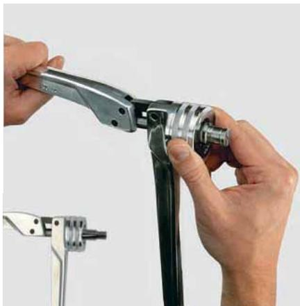
Nelle espansioni elettriche, inserire il dispositivo espansore nel portaforcelle A fino in battuta (finché avviene lo scatto) ed inserire poi quest'ultimo nell'utensile elettrico ESZ 2 o nell'utensile a batteria ASZA fino in battuta.
