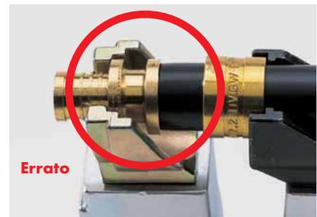
Posizionamento errato della forcilla F sul collare del raccordo. La giunzione subirà una sovrappressione.
