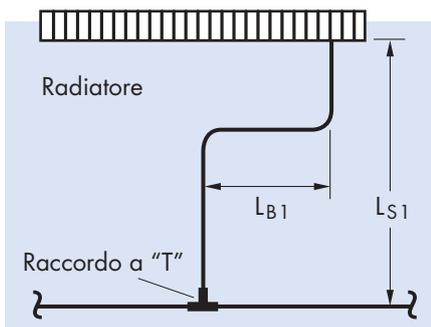
Una situazione analoga si verifica in presenza di lunghe tubazioni a pavimento per il collegamento dei radiatori. Si dovranno evitare sollecitazioni meccaniche sui raccordi di allacciamento alla valvola del radiatore, installando le tubazioni a forma di "S" oppure prevedendo un punto fisso prima del radiatore. Consigliamo questi accorgimenti se la lunghezza dell'allacciamento LS1 è superiore a 4 metri.
