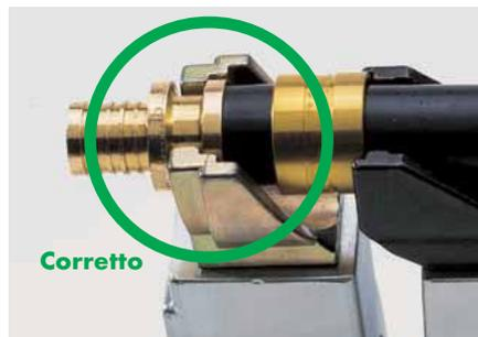
Posizionamento corretto della forcilla F sul collare del raccordo con MSZ.
