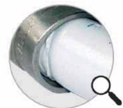
Curvare il tubo direttamente nel punto della giunzione pressata provoca rotture alla parete del tubo.
