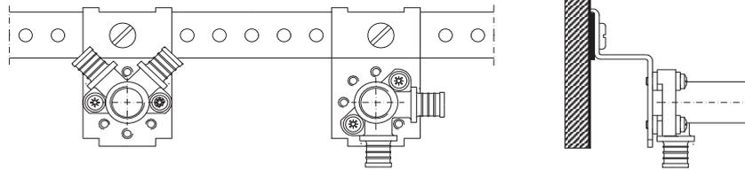
**Installazione a parete con supporto preforato variabile 80/400 senza pezzo ad U per collare tubo di scarico**
