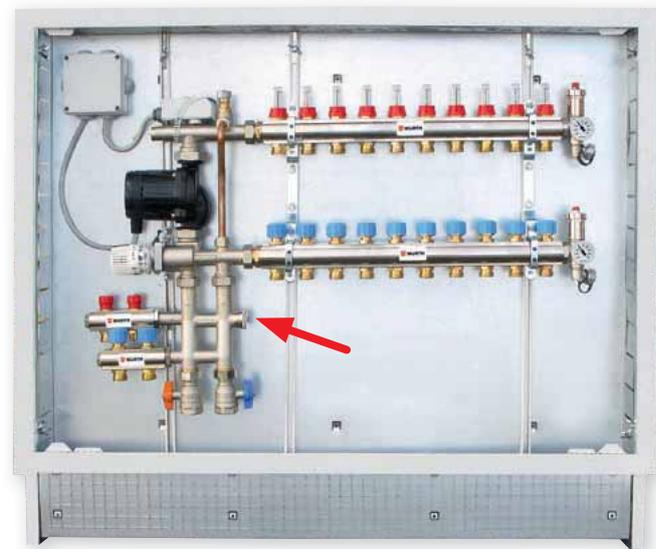
**Modello POSEIDON-AT2 e AT3:** come POSEIDON, ma con by-pass regolabile (1÷3 m.c.a.) per circuito primario (**Fig. 4**) e kit stacchi alta temperatura a 2 (**Fig. 2**) o 3 vie (**Fig. 3**) termostattizzabili sul collettore di ritorno, per l'alimentazione di eventuali radiatori
