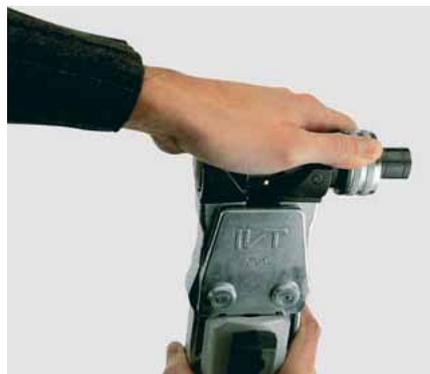
Tagliare ortogonalmente il tubo con il troncatubi a cricco o il tagliatubi. Scegliere la boccola adatta al tipo e al diametro del tubo (boccola color ottone per i tubi Flex neri, tubi Riscaldamento rossi e tubo RAP 20 grigio chiaro, mentre la boccola nichelata color argento per i tubi Stabil bianchi ed i tubi RAP 17 grigio e grigio chiaro) ed applicarla alla tubazione facendola scorrere quanto basta, in modo da evitare che
