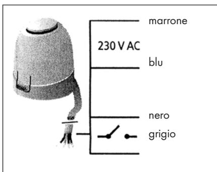
Per il collegamento delle testine al termostato o al cronotermostato ambiente ed all'eventuale pompa di circolazione, vedere le indicazioni alla pagina seguente.
