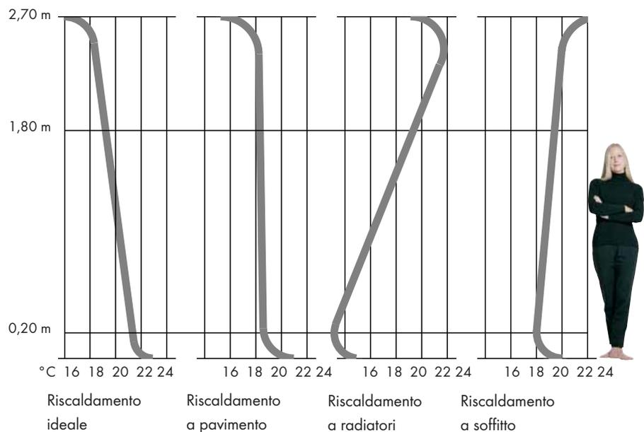
conseguenza la temperatura media superficiale del pavimento e delle pareti risulta superiore alla temperatura ambiente. Rispetto ai sistemi di riscaldamento tradizionali la temperatura ambiente potrà quindi essere abbassata di 1-2°C, mantenendo inalterato il comfort ambientale percepito.
