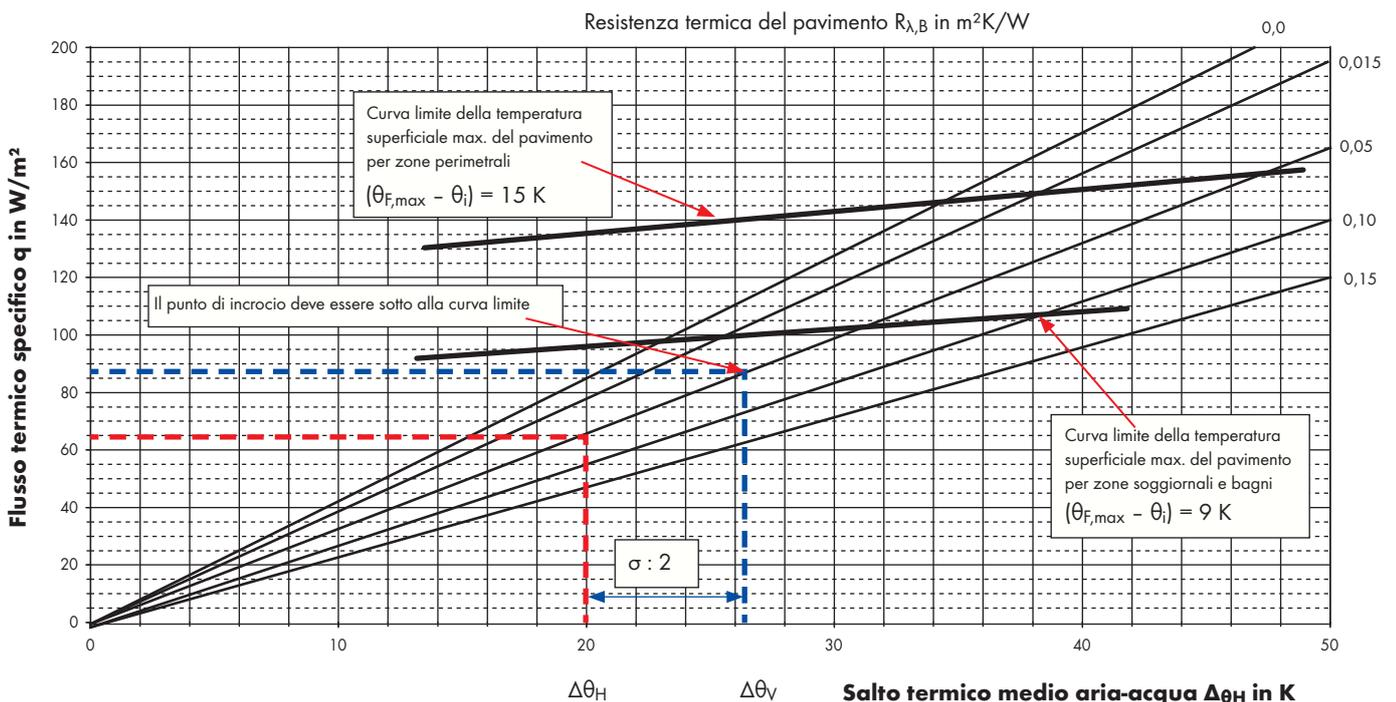
Nel diagramma d'esempio, il punto d'incrocio si trova esattamente sulla retta 0,05. Con un interasse di posa di 25 cm, il flusso termico specifico richiesto di 67  $W/m^2$  viene quindi fornito con un salto termico medio aria-acqua  $\Delta\theta_H$  di 20 K.
