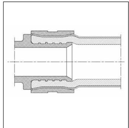
La chiusura a tenuta e la forza assiale di serraggio tra raccordo e tubo vengono garantite dalla pressione del materiale PE-X o PE-MDX provocata dalla boccola di scorrimento sul corpo del raccordo, senza l'impiego di alcun mastice aggiuntivo.
