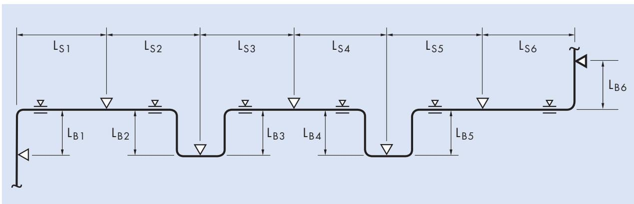
In caso di installazione lineare delle tubazioni dove non fosse possibile assorbire tutte le forze di dilatazione all'inizio ed alla fine dell'impianto, ad esempio cambiando di 90° la direzione delle tubazioni, si dovranno inserire dei compensatori angolari ad "omega" ( $\Omega$ ). La posizione dei punti fissi sarà stabilita dividendo
