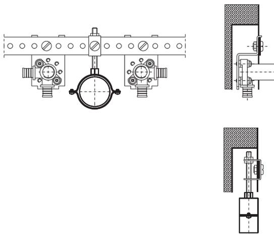
Pezzo ad U con barra filettata per il fissaggio del collare del tubo di scarico
