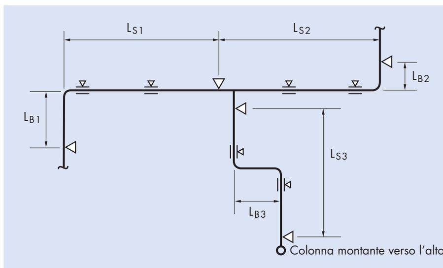
Se a causa di condizioni costruttive vengono applicati dei punti fissi sia all'inizio (ad es. il punto d'incrocio della tubazione principale) che alla fine (colonna montante verso l'alto) di un tratto di tubazione, le forze generate dovranno essere assorbite da un compensatore angolare ad "S", come rappresentato nel grafico a sinistra (sezione orizzontale).
