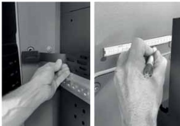
Segnare il punto di fissaggio sulla parete laterale del veicolo (sul montante).
