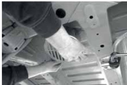
Segnare la posizione con una matita. Disegnare un cerchio intorno al cilindro della bocca di aerazione.
