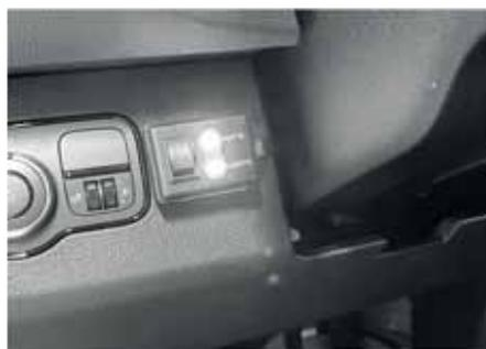
Quando si utilizza il telecomando, l'interruttore on/off del convertitore di tensione deve essere impostato su OFF.
