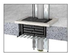
Lo spessore di una struttura inferiore a 250 mm deve essere aumentato con pannelli da costruzione non combustibili fino allo spessore richiesto di 250 mm. Usare una griglia di acciaio come supporto per i cuscini antifuoco
