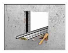
Pulire l'apertura e rimuovere i residui. Verificare che la distanza del supporto della passerella portacavi sia corretta sia in caso di parete che di solaio.
