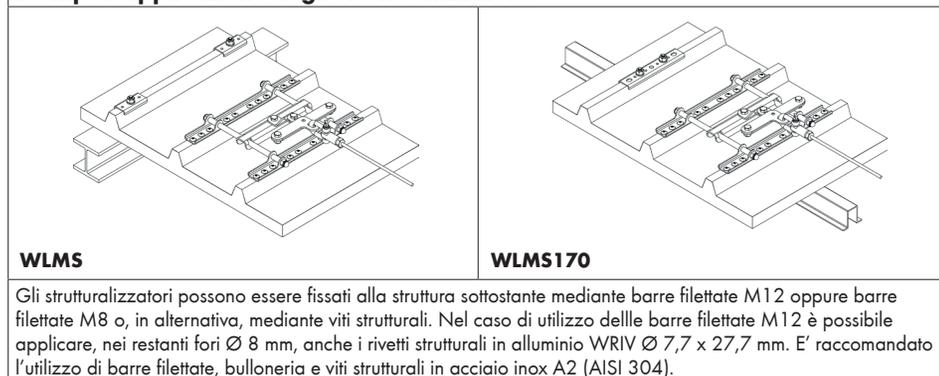
**Nota:** Il passo, la quantità e il verso di montaggio degli strutturalizzatori devono essere definiti dal progettista che è tenuto ad effettuare un'accurata verifica strutturale e funzionale della copertura
