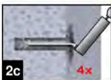
2c. Abschließend das Bohrloch erneut vom Bohrlochgrund her 4x vollständig mit Druckluft (min. 6 bar) (Annex B 7) ausblasen, bis die ausströmende Luft staubfrei ist. Bei tiefen Bohrlöchern sind geeignete Verlängerungen zu verwenden.
