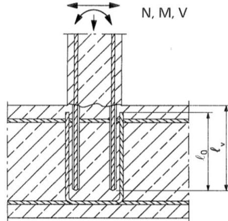
**Bild A3:** Endverankerung von Platten oder Balken
