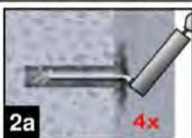
2a. Das Bohrloch vom Bohrlochgrund her 4x vollständig mit Druckluft (min. 6 bar) (Annex B 7) ausblasen, bis die ausströmende Luft staubfrei ist. Bei tiefen Bohrlöchern sind geeignete Verlängerungen zu verwenden.
