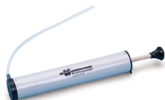
MAC - Handpumpe (Volumen 750 ml) Bohrerdurchmesser (d 0 ): 10 mm bis 20 mm Bohrlochtiefe (h 0 ): < 10 d s Nur im ungerissenen Beton
