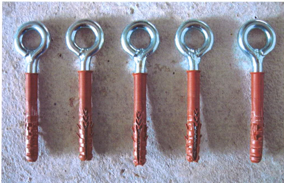
Fissaggi a prove terminate.
