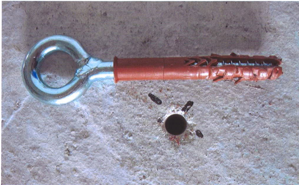
Fotografia della modalità di rottura dell'ancorante.
