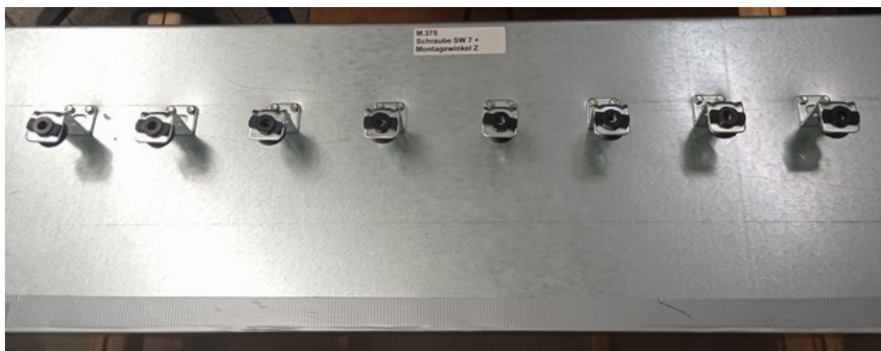
Immagine 7.33: Canale di areazione con 8 elementi angolari di fissaggio per canale di areazione Würth VARIFIX® di tipo 3 + 2 viti WÜRTH di tipo 2 per ciascun elemento
