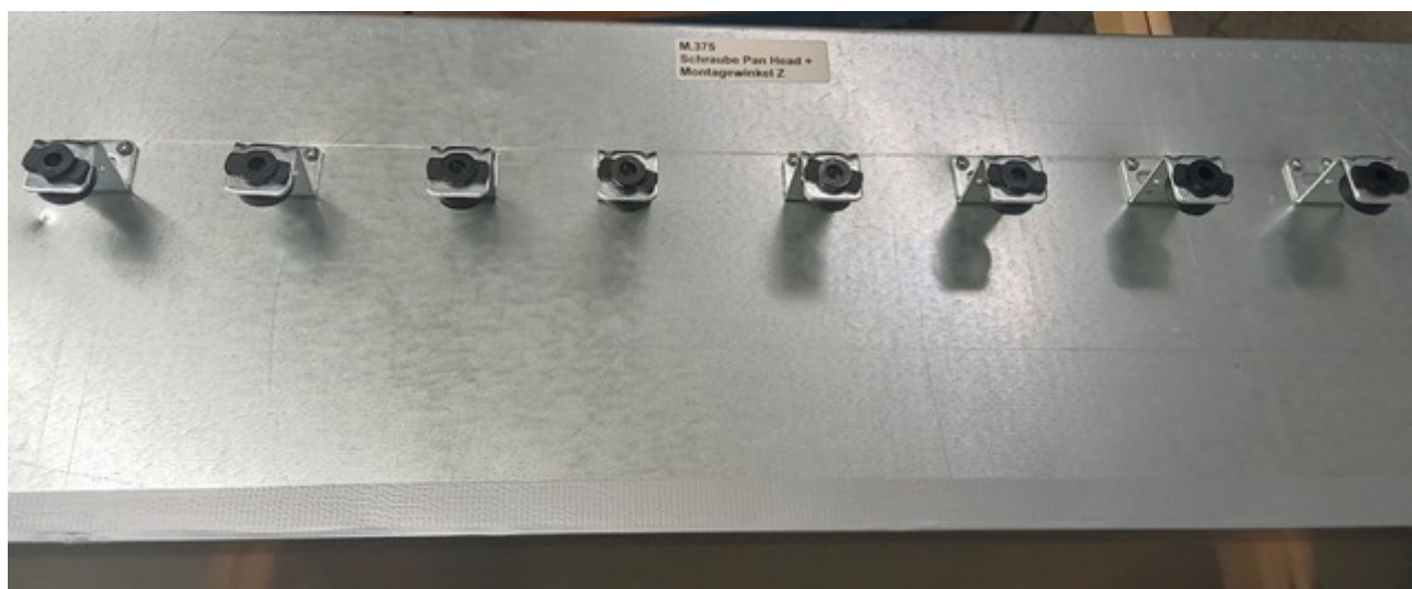
Immagine 7.17: Canale di areazione con 8 elementi angolari di fissaggio per canale di areazione Würth VARIFIX® di tipo 3 + 2 viti WÜRTH di tipo 1 per ciascun elemento
