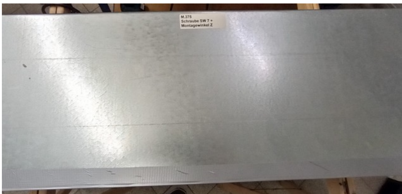
Immagine 7.30: Canale di areazione senza elementi angolari di montaggio per canali di areazione Würth VARIFIX® di tipo 3 + viti WÜRTH di tipo 2
