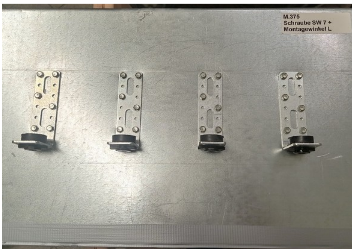
Immagine 7.24: Canale di areazione con 4 elementi angolari di fissaggio per canale di areazione Würth VARIFIX® di tipo 1 + 6 viti WÜRTH di tipo 2 per ciascun elemento
