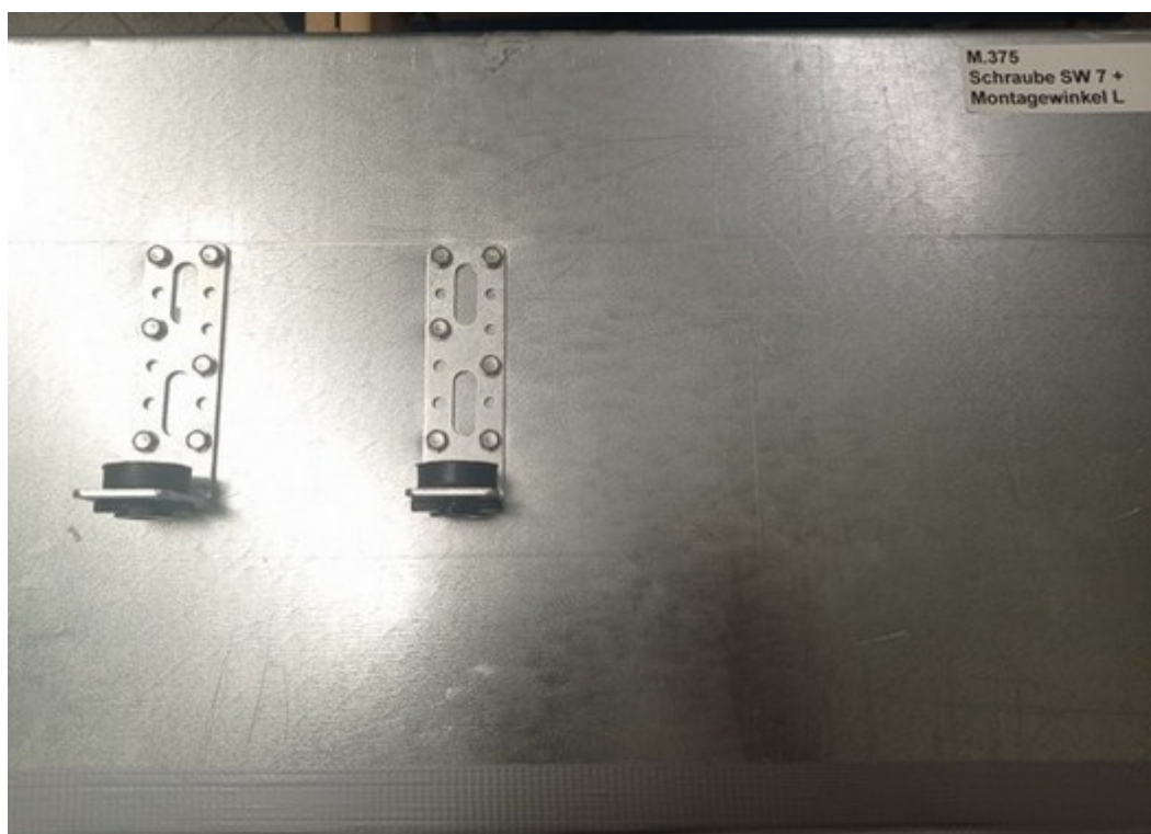
Immagine 7.23: Canale di areazione con 2 elementi angolari di fissaggio per canale di areazione Würth VARIFIX® di tipo 1 + 6 viti WÜRTH di tipo 2 per ciascun elemento
