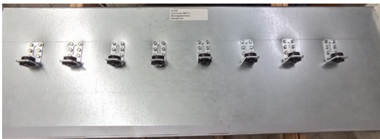
Immagine 7.29: Canale di areazione con 8 elementi angolari di fissaggio per canale di areazione Würth VARIFIX® di tipo 2 + 6 viti WÜRTH di tipo 2 per ciascun elemento
