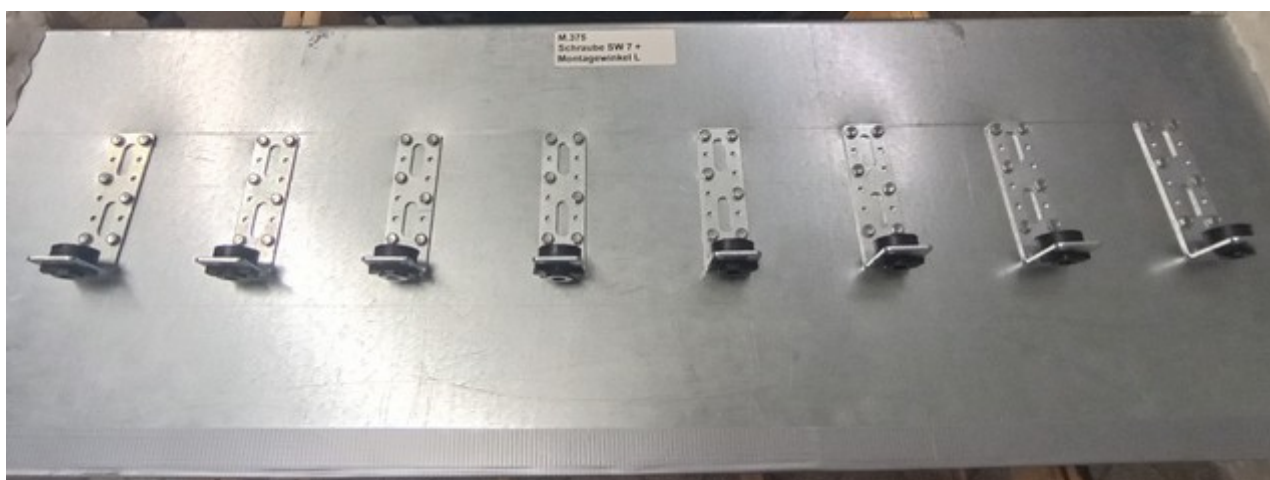
Immagine 7.25: Canale di areazione con 8 elementi angolari di fissaggio per canale di areazione Würth VARIFIX® di tipo 1 + 6 viti WÜRTH di tipo 2 per ciascun elemento
