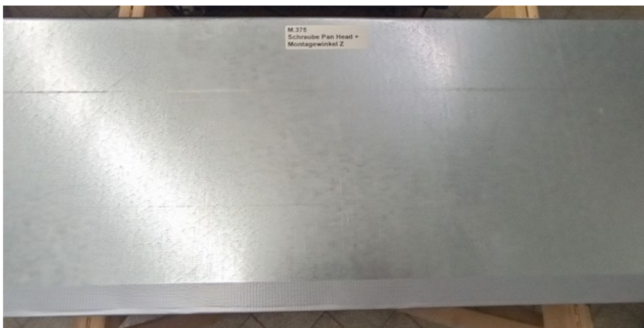
Immagine 7.14: Canale di areazione senza elementi angolari di montaggio per canali di areazione Würth VARIFIX® di tipo 3 + viti WÜRTH di tipo 1
